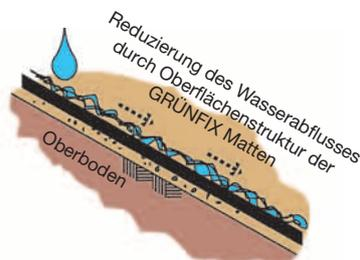
**Bild 2: Erosionsschutz**
